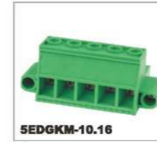
5EDGKM-10.16 600V/57A 0.5-10.0mm 2 300V/52A 20-6AWG Poles 2P-9P
