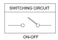
ROCKER SWITCH MODEL MR-5 SERIES RATING:3A 250VAC (UL/CUL) 6A 125VAC (UL/ CUL) 3A 250VAC~  $\mu$ T100/55(VDE/ENEC/CQC) DIELECTRIC VOLTAGE-WITHSTAND:1,000VAC FOR 1 MINUTE INSULATION RESISTANCE:DC 500V 100M $\Omega$  (MIN.) CONTACT RESISTANCE:20m $\Omega$  INITIAL (MAX.)
