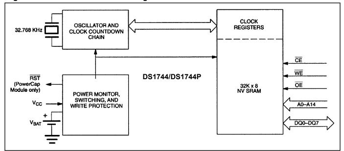
Figure 1. DS1744/DS1744P Block Diagram
