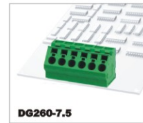
DG260-7.5 630V/32A 0.2-4.0mm 2 300V/30A 24-10AWG Poles 1P-XXP
