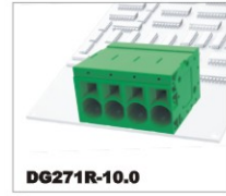
DG271R-10.0 1000V/76A 0.2-16.0mm 2 600V/70A 20-4AWG Poles 1P-XXP
