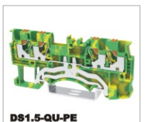
DS1.5-QU-PE CE — 0.14-1.5mm 2 UL — 26-14AWG T/W/End plate 3.5/63.2/1.5mm
