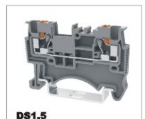
DS1.5 CE 500V/17.5A 0.2-1.5mm 2 UL 600V/15A 26-14AWG T/W/End plate 3.5/45/1.5mm
