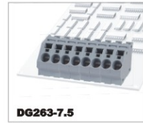
DG263-7.5 630V/41A 0.2-6.0mm 2 300V/30A 24-10AWG Poles 1P-XXP
