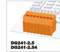
DG241-2.5 DG241-2.54 130V/6A 0.2-0.5mm 2 150V/5A 28-20AWG Poles 1P-XXP
