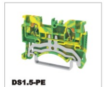
DS1.5-PE CE — 0.2-1.5mm 2 UL — 26-14AWG T/W/End plate 3.5/45/1.5mm
