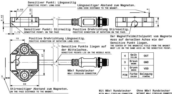
Die Buchse muss vollflächig aufliegen und die Anschraubfläche muss Eben sein. -M4 Senkschraube (8.8) THE SOCKET MUST REST COMPLETELY OVER THE ENTIRE SURFACE AND THE MOUNTING SURFACE MUST BE FLAT. -M4 FLAT HEAD SCREWS (8.8)
