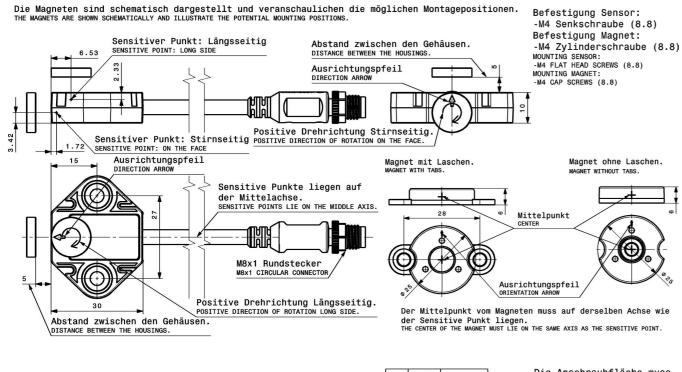
4 Gelb YELLOW Mit M8x1 Rundstecker Ohne M8x1 Rundstecker WITHOUT M8x1 CIRCULAR CONNECTOR WITH M8x1 CIRCULAR CONNECTOR 3 Braun BROWN Pin 4 1 Gruen GREEN K02 PIN Farbe Pin 1
