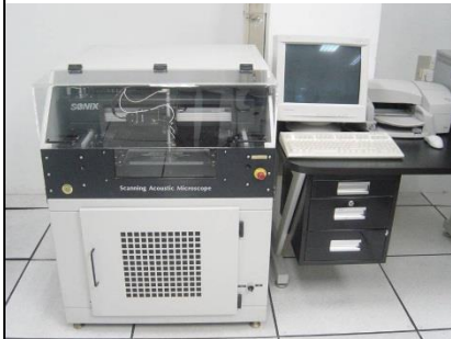
TOOL : SAM BRAND/MODEL : SONIX / URH-2000 APPLICATION : DELAMINATION
