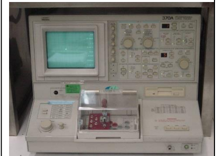
TOOL : CURVE TRACER BRAND/MODEL : TEKTRONIX / 370A APPLICATION : PARAMETER
