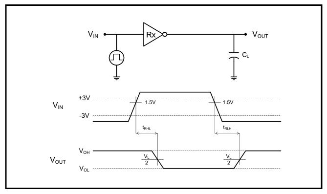
FIGURE 9. RS-232 DRIVER PROPAGATION DELAY
