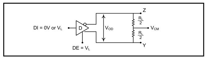
FIGURE 6. RS-485/422 DIFFERENTIAL DRIVER OUTPUT VOLTAGE OVER COMMON MODE
